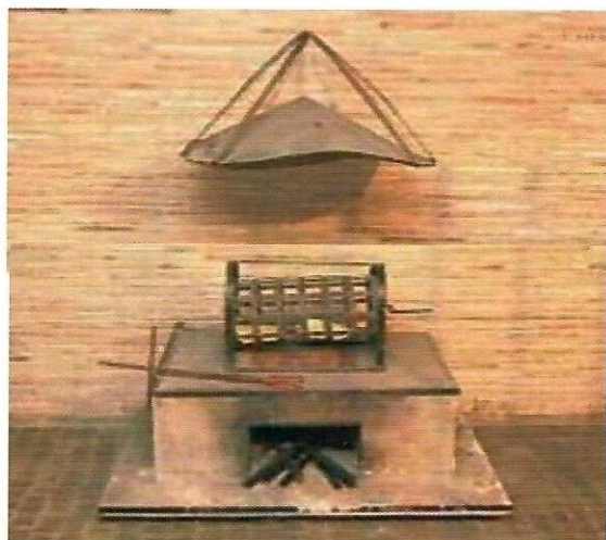
Figura 1. Fornello impiegato in periodo di epidemia per la disinfezione di lettere in transito per Roma. In basso il fornello per produrre i fumi utili allo scopo, sopra un cestello in ferro ruotante per contenere le lettere, in alto una cappa per ridurre la dispersione dei fumi.
